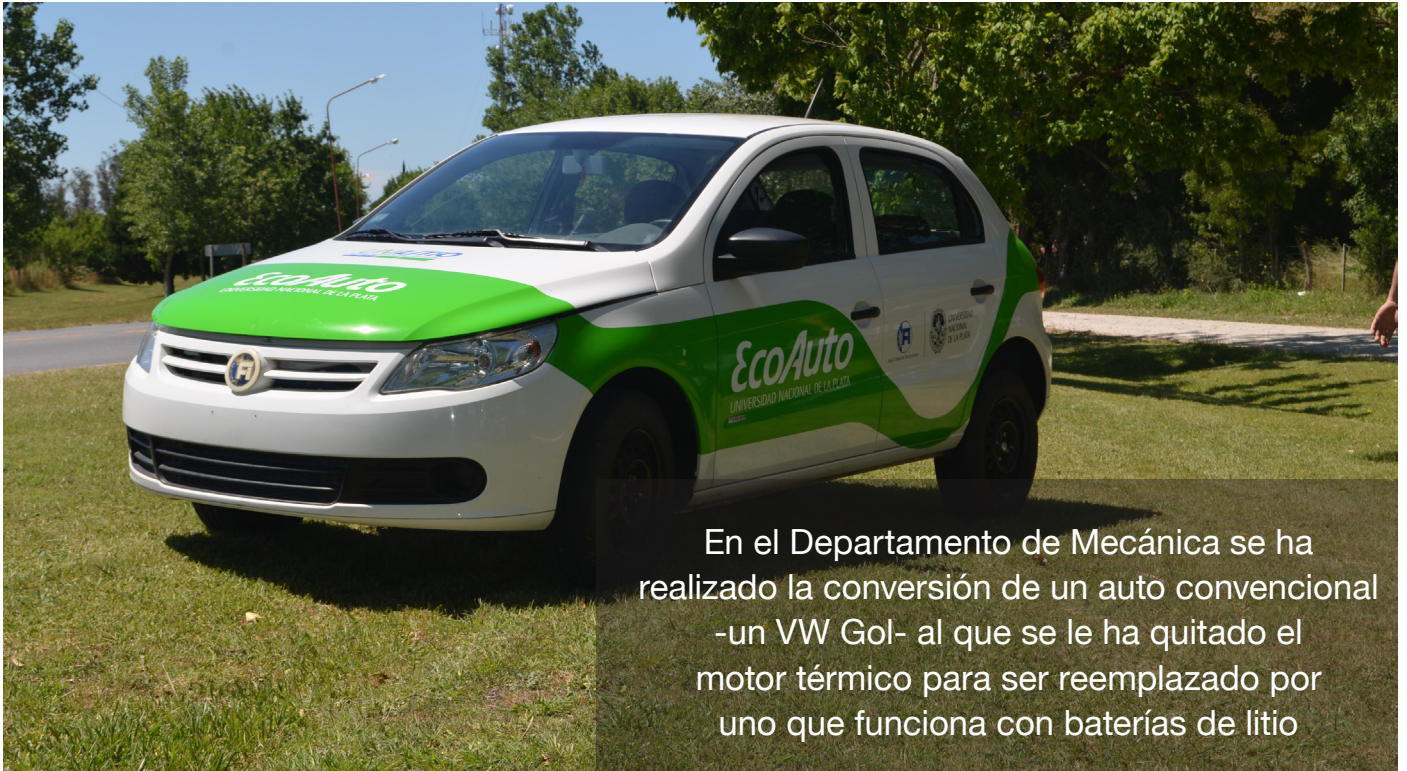
Vehículo VW Gol adaptado con baterías de litio. Un proyecto del cual participaron integrantes de los departamentos de Mecánica y Aeronáutica
